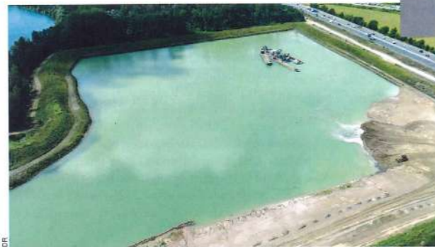
La carrière en eau des Rives du Beaujolais, à Anse (69), couvre 35 % des besoins en granulats du groupe. Cette exploitation produit 350 000 t par an au moyen d'une drague à chaîne et godets.
