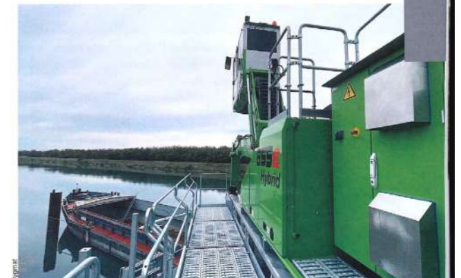
La politique matériel que Pradier met en œuvre tend à diminuer l'empreinte carbone de ses engins. Témoins des derniers investissements, deux pelles électriques Sennebogen, l'une au port Edouard Herriot l'autre à Mondragon.
